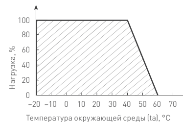
Рис. 3. Максимальная допустимая нагрузка, % от мощности источника
