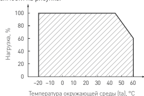
Рис. 1. Максимальная допустимая нагрузка, % от мощности источника
