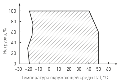
Рис. 2. Максимальная допустимая нагрузка, % от мощности источника
