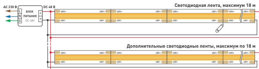
Схема 2. Подключение нескольких светодиодных лент с двух сторон
