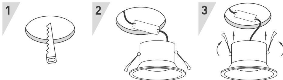
Рис. 2. Установка и подключение светильника
