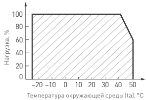
Рис. 2. Максимальная допустимая нагрузка, % от мощности источника
